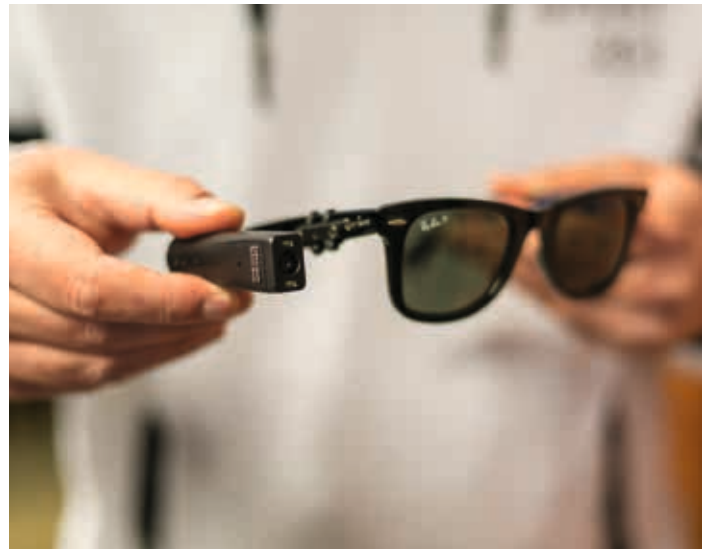
Die Sehhilfe Orcam wird auf die Brille montiert und kann Texte vorlesen oder Personen erkennen.
